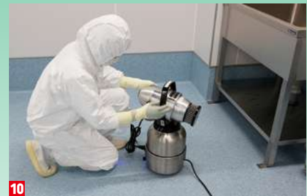
6,7 微生物検査フロアの「第2処理室」にある自動化装置(6)と無菌空間装置(7) / 8 微生物検査フロアにある食中毒菌判定・カビ同定などを行う部屋 / 9 ケミカル室での過酢酸サイクル除染®システムを使った検証試験 / 10 ケミカル室での過酢酸系除菌剤(ミンケア)によるドライフオグ除染の様子
